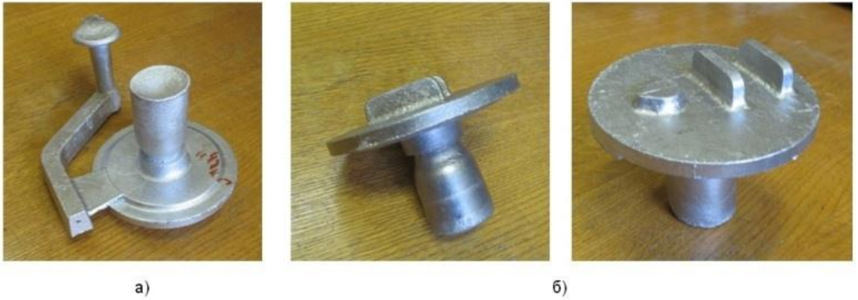
Рис. 1. Отливка типа «Диск»: а – гравитационная заливка; б – литье под электромагнитным давлением.
