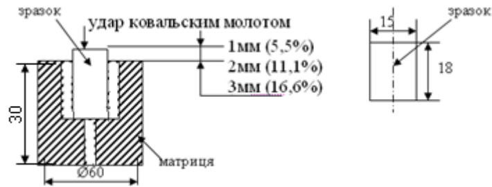
Схема ударного деформування зразків
