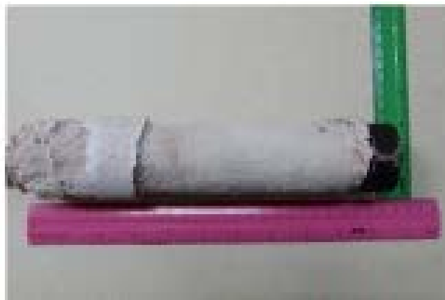
Рис. 1. Вигляд моделі заглибної фурми до (а) та після закінчення експерименту (в), схема виділення «зон» на футерівці (б)
