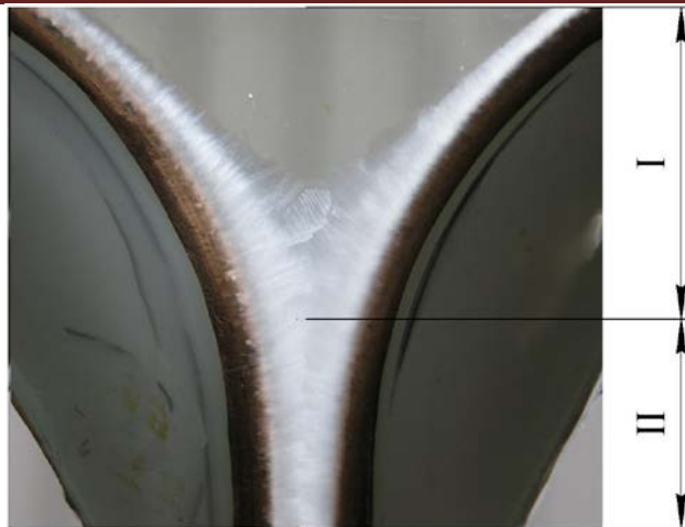
Рис. 1 – Схема отримання листової заготовки з камфену при його беззлитковій прокатці: I – зона кристалізації; II – зона прокатки
