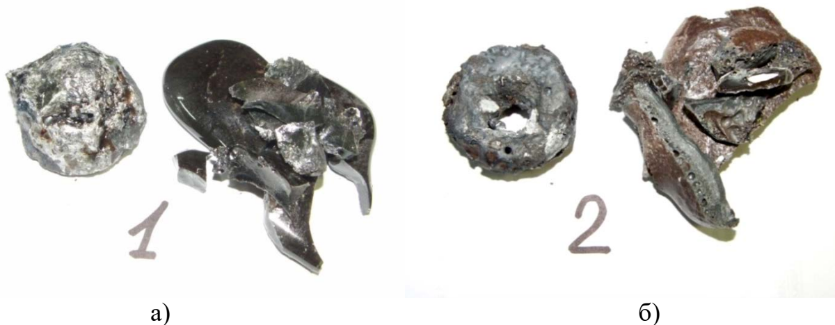
Рис. 2. Вигляд зливків металу та шлаків, що отримані в результаті переплаву проб №1 (а) та №2 (б)
