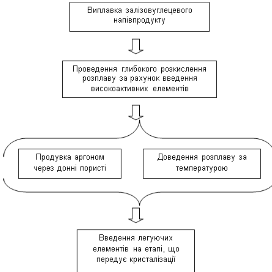
Рисунок – Загальна схема прогресивного способу розкислення та легування металевих розплавів
