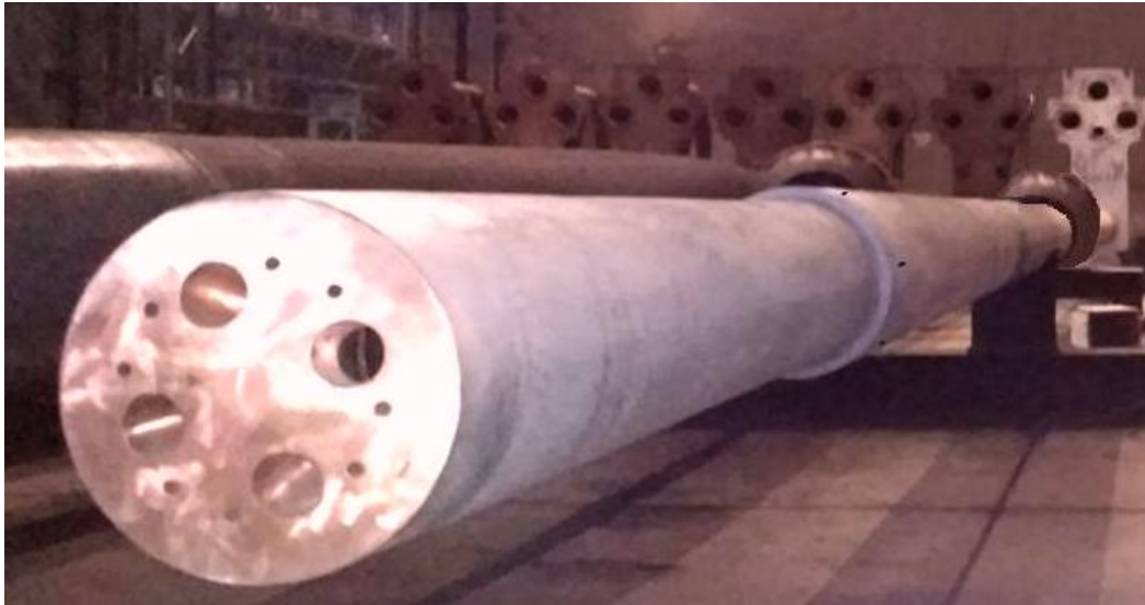
Рис. 1 – Прогрессивная конструкция двухъярусной кислородной фурмы
