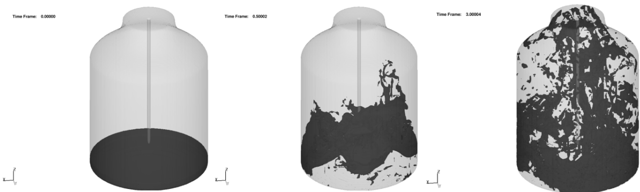
Рис. 2 – Результаты моделирования разбрызгивания шлака в программе FLOW-3D с пятисопловым наконечником фурмы: а – 0 сек., б – 0,5 сек., в – 3 сек.
