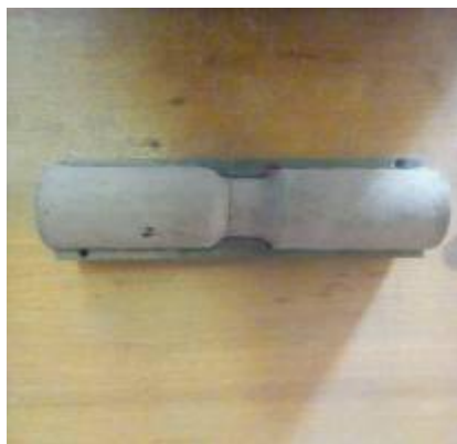
Рисунок 4.9 – Ливарні стрижні з фосфатом цирконію після зміцнення в гарячому оснащенні
