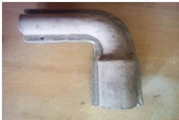
Рисунок 4.9 – Ливарні стрижні з фосфатом цирконію після зміцнення в гарячому оснащенні
