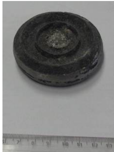
Рисунок 5.55 – Виливок із сталі 25Л, виготовлений із застосуванням суміші з ортофосфорною кислотою і нітратом алюмінію
