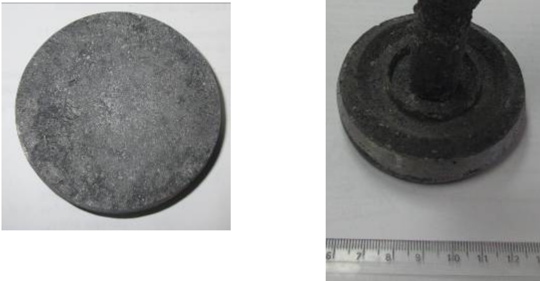
Рисунок 5.62 – Виливок із сталі 25Л, виготовлений із застосуванням суміші з ортофосфорною кислотою і гідрофосфатом алюмінію
