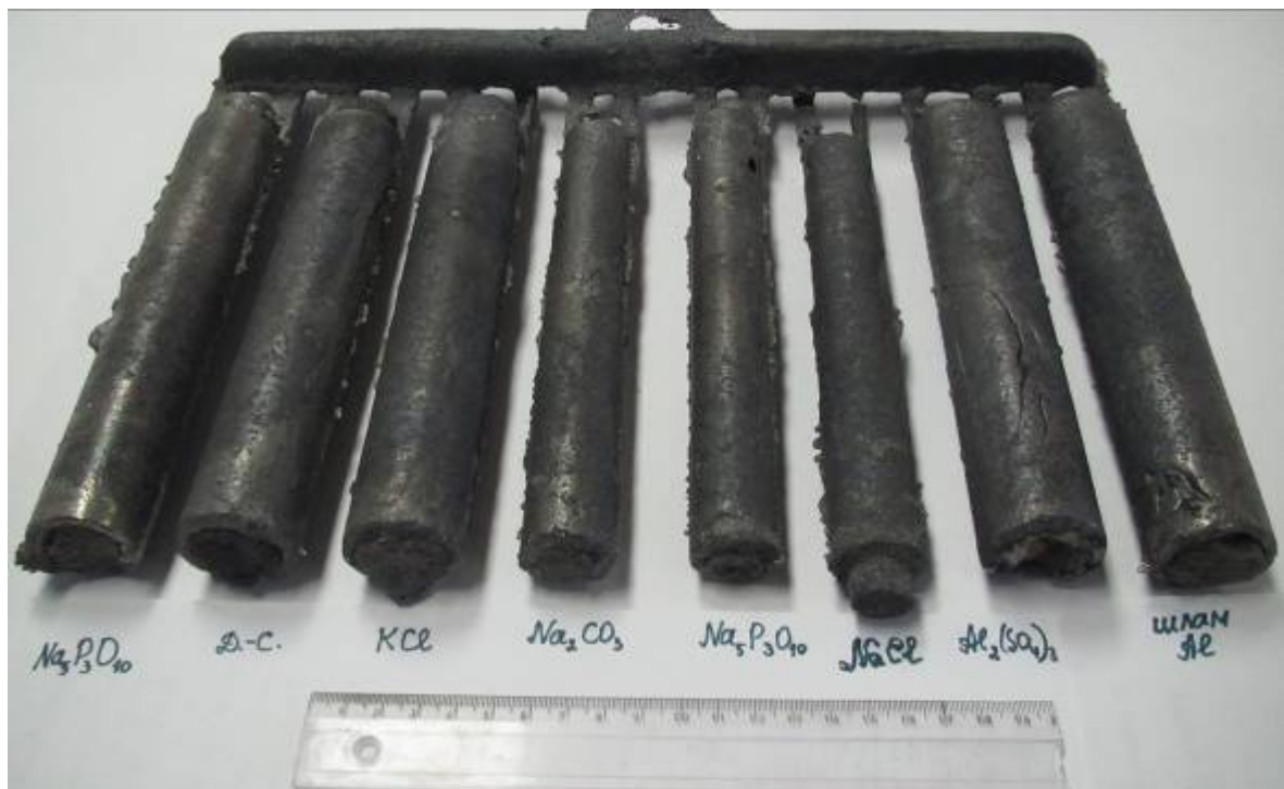
Рисунок 6.30 – Блок виливків «Насадка пальника котлоагрегата ТЕС» із сталі 30Х25Ю2ТЛ, виготовлених із використанням розроблених стрижневих сумішей
