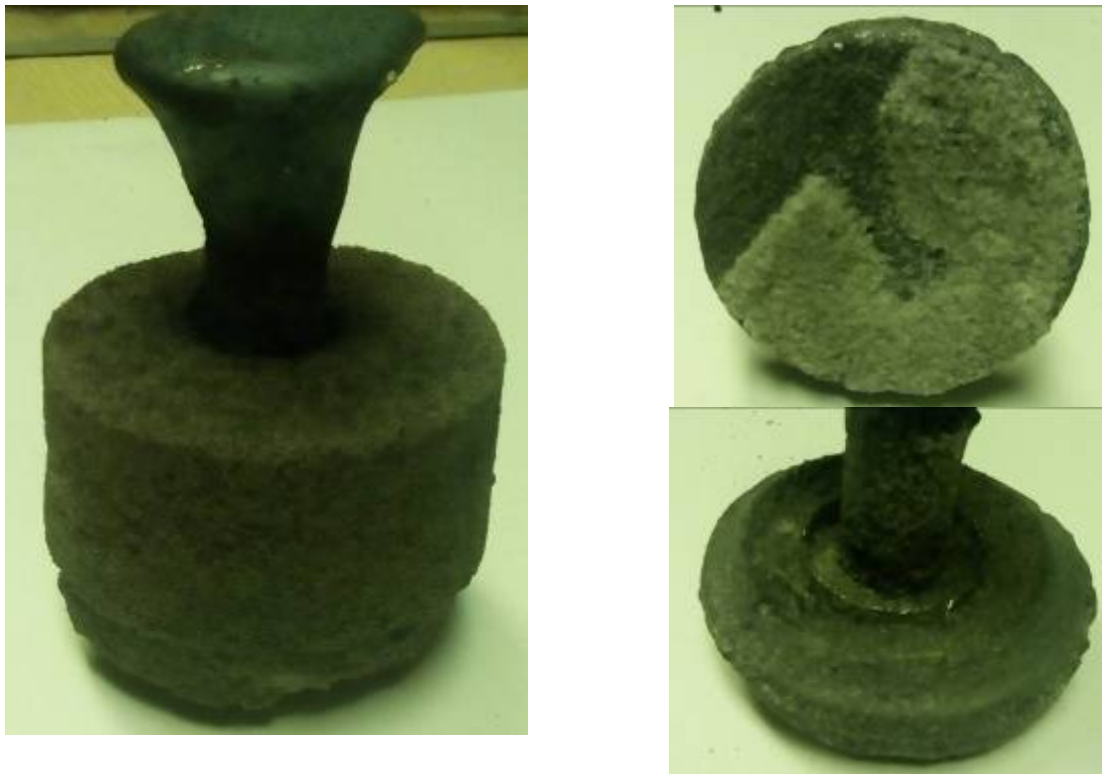
Рисунок 5.19 – Оболонкова форма із ортофосфорною кислотою і сульфатом заліза у залитому стані (а) та зовнішній вигляд виливка із СЧ25 (б, в)
