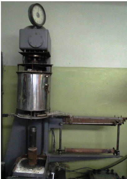
Рисунок 2.1 – Установка УС-700 для визначення міцності стандартних зразків суміші при стисканні
