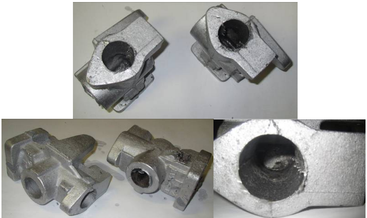
Рисунок 6.32 – Виливки із сплаву АК12, температура заливання 680^\circ\text{C} , виготовлені із застосуваннями стрижнів із сухими ЗК на основі \text{Al}_2(\text{SO}_4)_3 \cdot 18\text{H}_2\text{O} і \text{H}_3\text{PO}_4 , \text{MnSO}_4 \cdot 5\text{H}_2\text{O} і \text{H}_3\text{PO}_4 , триполіфосфату натрію і \text{H}_3\text{PO}_4
