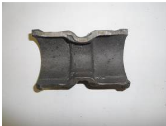
Рисунок 4.10 – Виливки (СЧ20) у розрізі, виготовлені з застосуванням ливарних стрижнів з фосфатом цирконію
