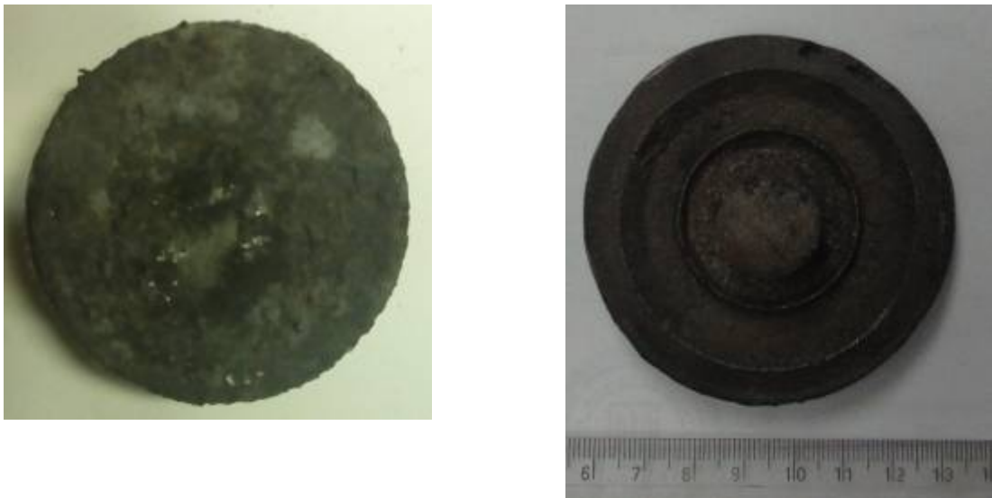
Рисунок 5.40 – Зовнішній вигляд виливка із СЧ 25, виготовленого в оболонковій формі із ортофосфорною кислотою і хлоридом калію
