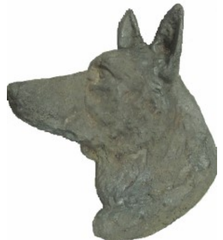
Рисунок 5.63 – Оболонкова форма після заливання (а), виліток із чавуну СЧ25 (б, в) та виліток із сталі 20Х25Ю2ТЛ (г), виготовлені із застосуванням суміші з ортофосфорною кислотою і триполіфосфатом натрію
