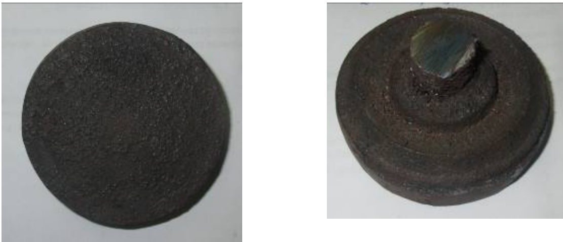
Рисунок 5.21 – Зовнішній вигляд виливка із сталі 25Л, виготовленого в оболонковій формі із ортофосфорною кислотою і сульфатом алюмінію
