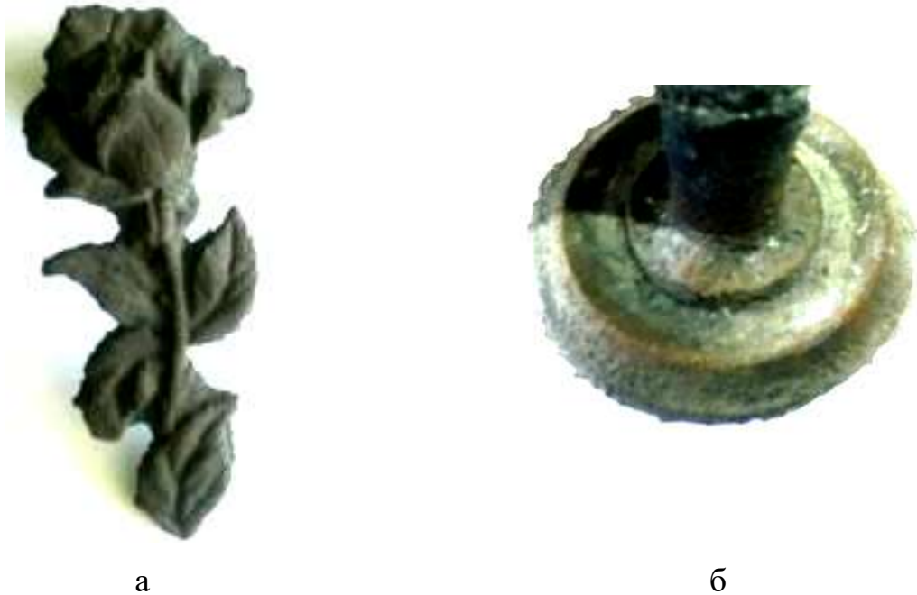
Рисунок 4.8 – Виливки, виготовлені у формах із експериментальної суміші з фосфатами кремнію: а – Троянда (сталль 20Л), б – Диск (сталль 20Л)
