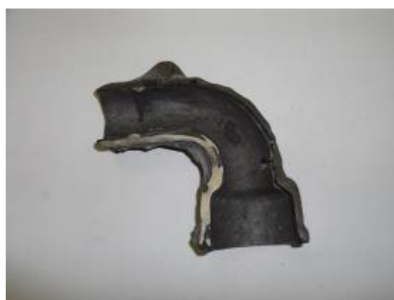
Рисунок 4.10 – Виливки (СЧ20) у розрізі, виготовлені з застосуванням ливарних стрижнів з фосфатом цирконію
