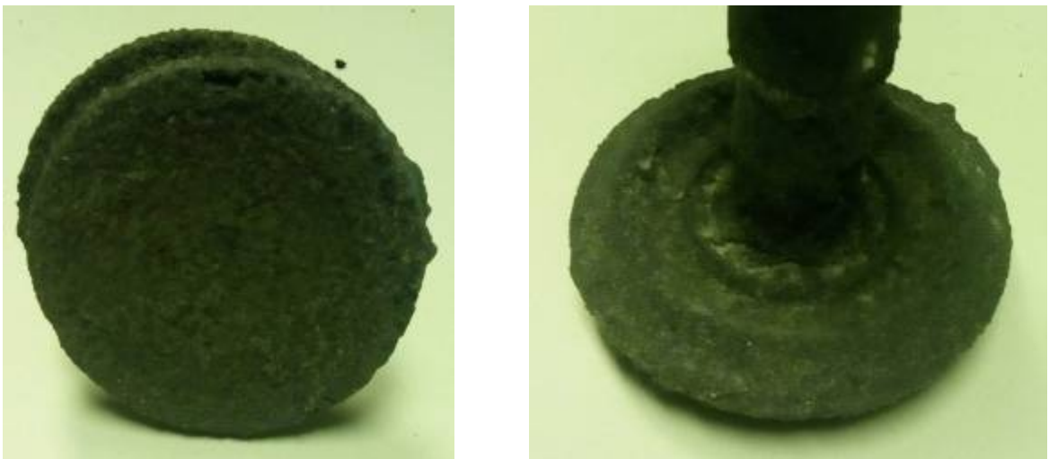
Рисунок 5.20 – Зовнішній вигляд виливка із СЧ25, виготовленого в оболонковій формі із ортофосфорною кислотою і сульфатом марганцю
