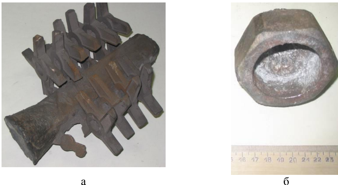
Рис. 24 – Виливки, виготовлені методом лиття за моделями, що витоплюються, із використанням алюмофосфатної суміші: а – блок виливків «Ніж м'ясорубки», сталь У10; б – виливок «Гайка», сталь 40Х13Л
