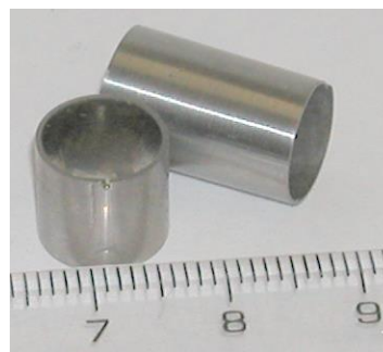
Рисунок 3. Моногранні трубки для термоемісійних перетворювачів (виготовлено із монокристалу вольфраму)
