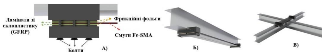
Рисунок 2. Схематичне зображення системи механічного анкерного кріплення на основі тертя для смуг Fe-SMA у сталевих конструкціях: А) Деталі конфігурації; Б) Посилення металевих балок; В) Посилення металевих з'єднань
