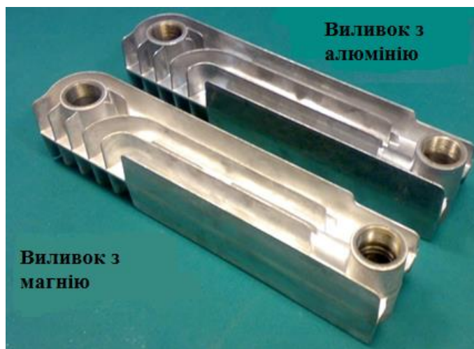
Рис. 7 Конструкція радіаторів з алюмінієвих і магнієвих сплавів з міжосьовими відстанями 300 мм
