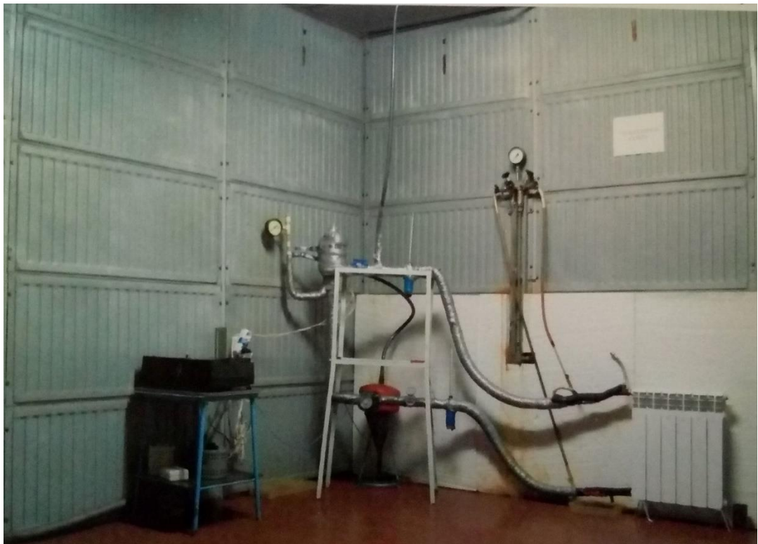
Рис. 5.17 Стенд для дослідження експлуатаційних характеристик радіаторів з магнієвих та алюмінієвих сплавів
