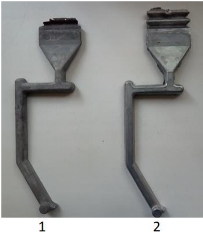
Рис. 5.2 Лабіринтові ущільнення. 1- магнієвий варіант, 2- алюмінієвий варіант
