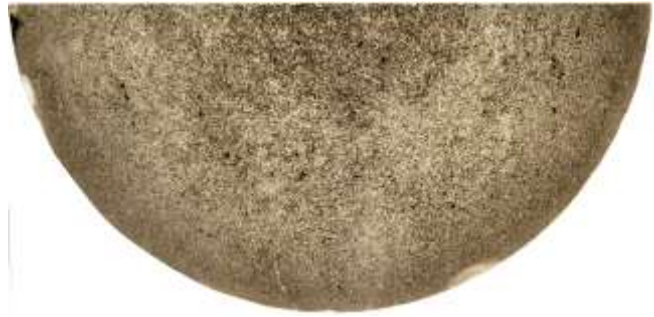
Рис. 15 – Сірчаний відбиток з бочки Ø450 мм відбіленого чавуну з включеннями MnS
