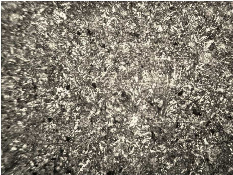
Рисунок 4.2 – Мікроструктура ділянки зразка від плити з усадковими порами, \times 100
