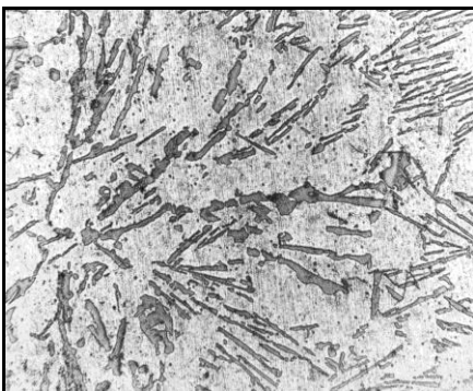
Рисунок 24 – Фрагмент мікроструктури (×200) ливарного Al -сплаву (силуміну евтектичного складу) марки АК12
