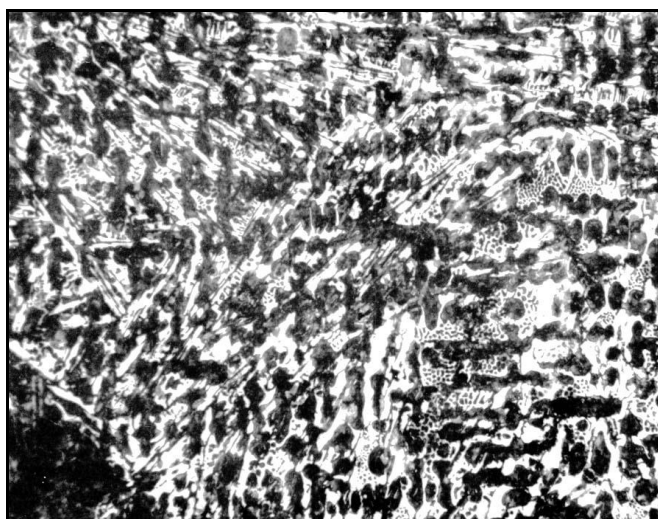
Рисунок 3.5 – Мікроструктура ( \times 100 ) білого чавуну у контрольній площині литих зразків: a...e – темплеті, помічені індексами: « K-1 », « K-2 », « K-4 », « K-5 », « K-7 », « K-8 », відповідно
