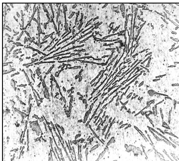
Рисунок 4.9 – Мікроструктура ( \times 200 ) ливарного Al-сплавy марки AK12 по висоті литого зразка: a...e – темплети з індексами «1-A»...«6-A», відповідно
