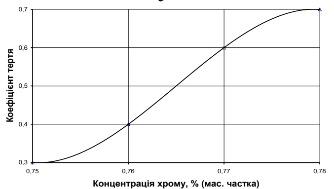
Рисунок 4.7 – Залежність триботехнічних властивостей нульмірного ЛКМ системи Cu-FeCr від концентрації заліза (а, в, д, є) та хрому (б, г, е, ж) в об'ємі литого зразка: а, б – зношування виливка; в, г – швидкості зносу литого зразка; д, е – спрацювання матеріалу контртіла; є, ж – коефіцієнта тертя ковзання пари Композитний виливок – Контртіло
