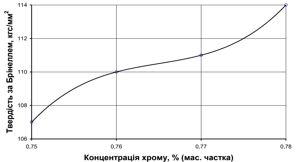
Рисунок 4.5 – Розподіл твердості підослідного матеріалу по висоті литого зразка: a – нульмірний ЛКМ системи Cu-FeCr , в – ливарна латунь марки ЛЦ16К4; вплив концентрації продуктів термічної дисоціації інтерметалідної армуючої фази на твердість композитного виливка: б – заліза; г – хрому
