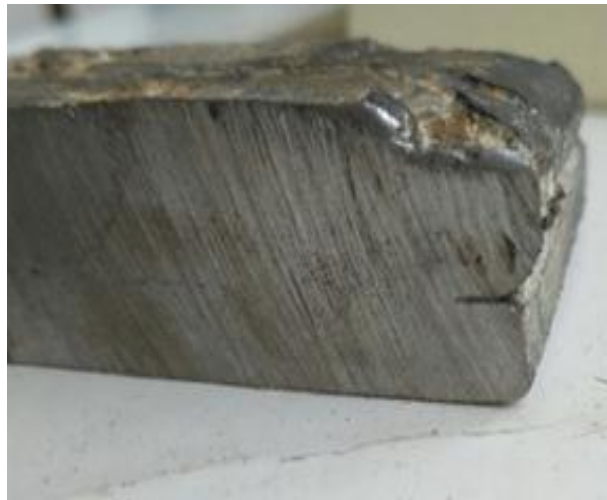
Рис.3.18. Зразок із термітної шихти нагрітої до 873К і додаванням металевго наповнювача (залізний порошок) 40%.
