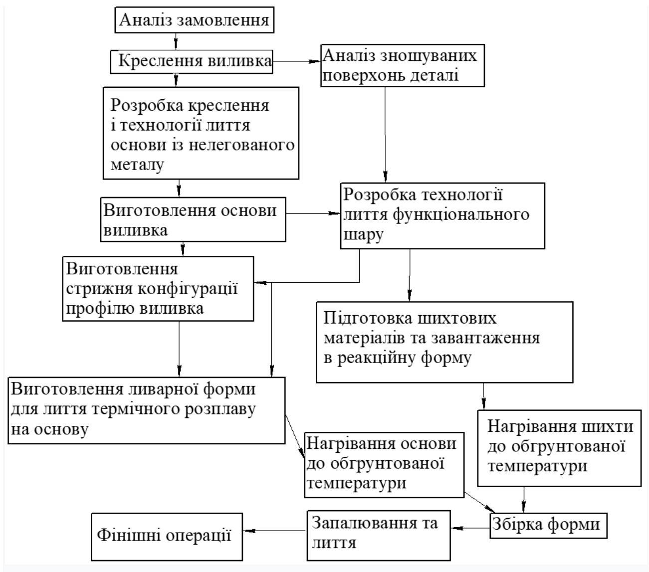
Рис. 5.1. Схема виробничого процесу виготовлення виливків
