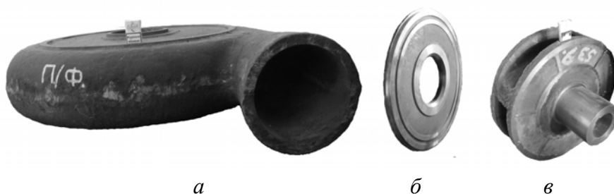
Рис. 31 Деталі багерного насоса із хромомарганцевого чавуну: корпус (а), диск (б), колесо (в)
