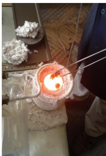
Рис. 5.2. Введення додаткової порції мідної шихти в тигель лабораторної індукційної печі з частотою 42 кГц
