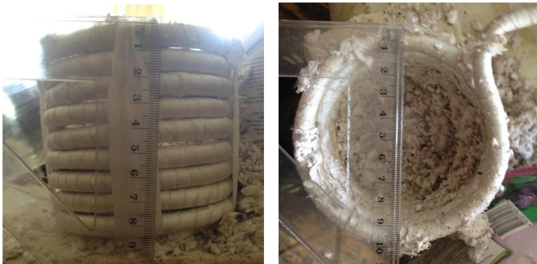
Рис. 2.1. Зовнішній вигляд та геометричні розміри індуктора лабораторної високочастотної ІТП:
