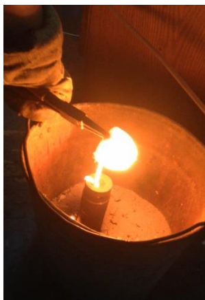
Рис. 5.6. Процес одержання макрозразку з емульсованого сплаву Cu-FeCrC, виплавленого у високочастотній ІТП
