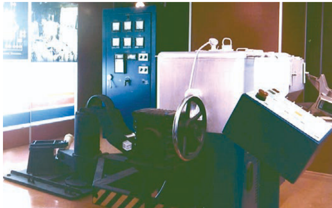
Ливарна МГД- установка для виплавки алюмінієвих сплавів
